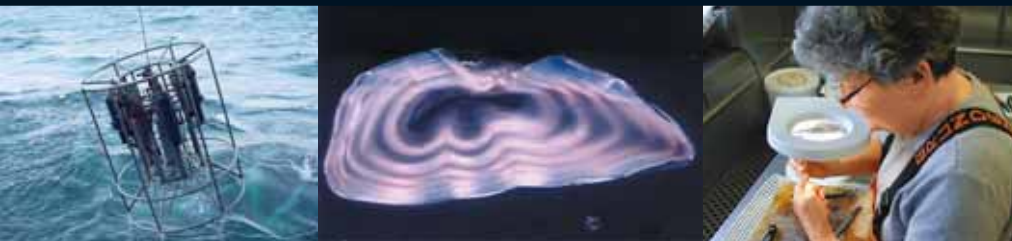
Mit dem Wasserkranzschöpfer werden Wasserproben zur Feststellung von Qualität, Temperatur und Sauerstoffgehalt entnommen. Mikroskopischer Querschnitt durch einen Otolithen (Gehörstein der Fische). Die kreisrunden Linien zeigen die Jahresringe, hier einer etwa 6-jährigen Makrele. Präparieren eines Otolithen im Labor.
